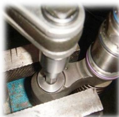
**Примечание:** При процессе зажимания затычки тарированный ключ нужно настроить на 55 Ньютон-метр.
