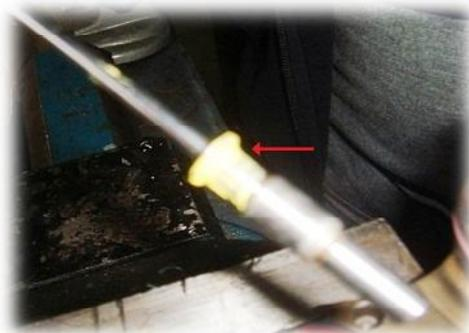
14. Теперь вставляем смазанный клапан в притирнутое седло с помощью шестигранного ключа (3мм) а также слегка надавливая на клапан пытаемся оставить след на клапане (поворачивая налево-направо).
