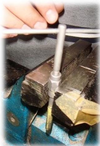
**Примечание:** Аппараты притирки разработаны с точки зрения регулировки любого размера. (6,995 мм -7,080 мм).
