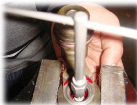
Таким образом восстанавливаем в прежнее состояние разрушенную поверхность ТНВД.
