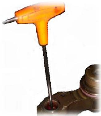
13. После того как убедились в размере клапана смазываем конусную часть клапана алмазной пастой как на рисунке (на широкую сторону).
