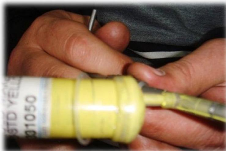
7. Теперь, приступаем к притирке для адаптации нового клапана в седло клапана. Сверху слегка придавливая на аппарат притирки седла клапана крутим направо-налево. Продолжаем данному действию 15-20 секунд. Здесь важно подобрать размер клапана наиболее плотно входящий (выходящий) в седло.
