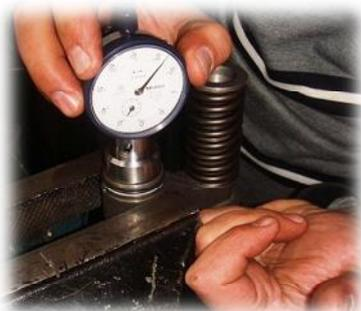
Хорошенько надавливаем на циферблатный индикатор, после того как убедились что устройство циферблатного индикатора плотно село обнуляем индикатор.
