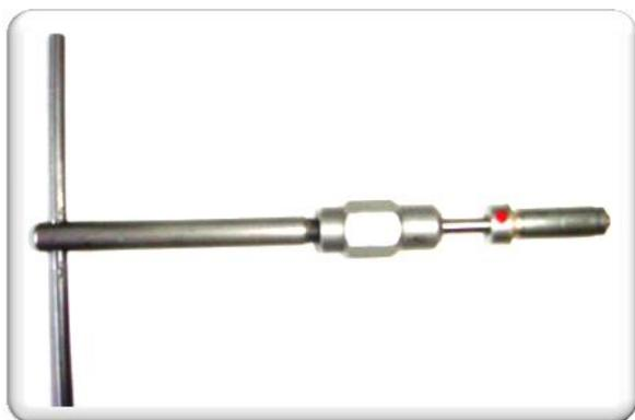
9. Аппарат корректировки качества поверхности конуса седла клапана (с зеленой точкой)
